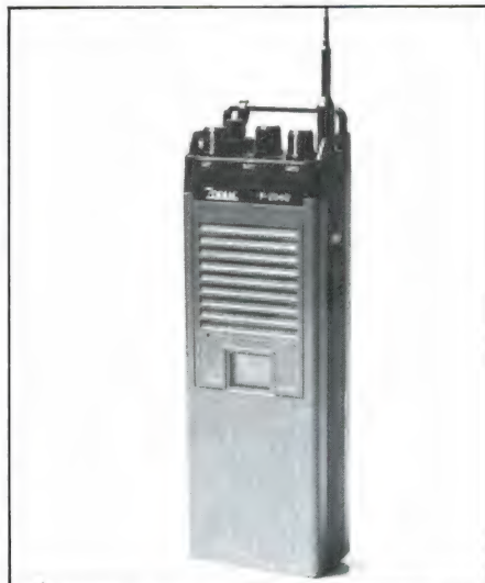
ZODIAC P 2040 27 MHz portofoon met 40 kanalen, beschikbaar gesteld door ARS ELOPTA, Amsterdam
